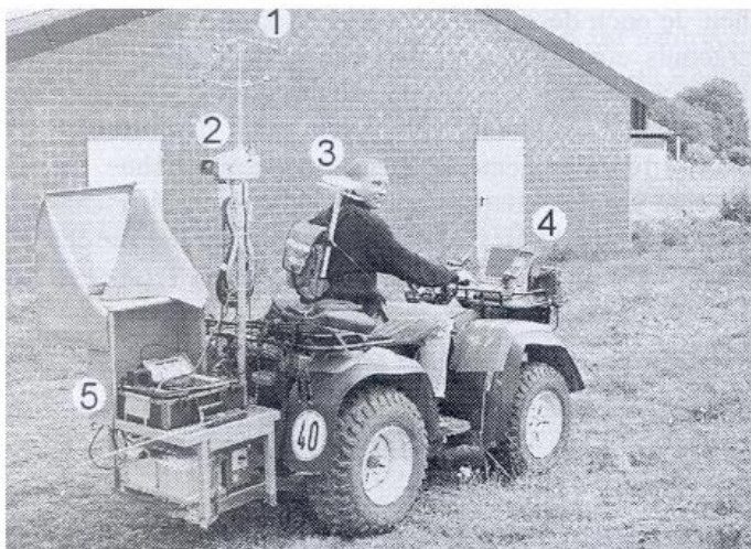
Slika 13: Merilno vozilo za mobilno meritev s testnim (tracer) plinom (po Boeker P. in sod., 2001)
