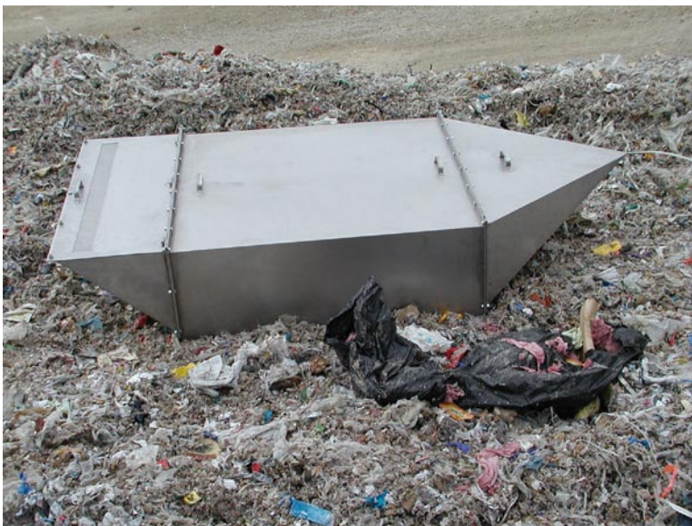
Fotografija 4: Vzorčevalna napa za vzorčenje zraka s površine
