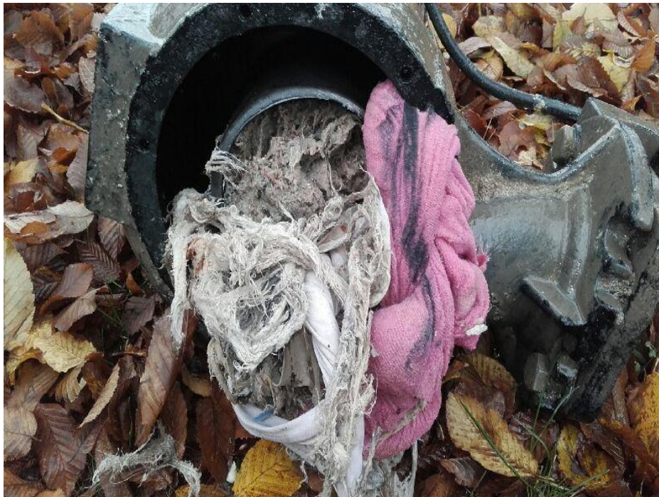
Slika 3: zamašitev črpalke s tekstilom
