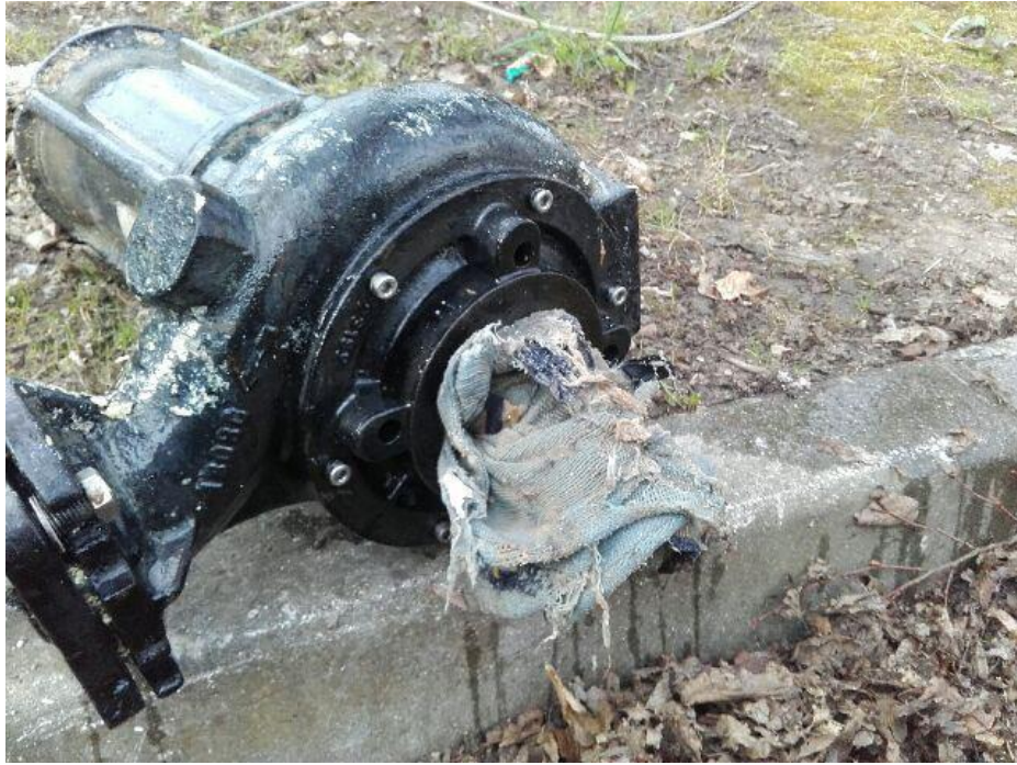
Slika 2: Zamašitev črpalke z brisačo
